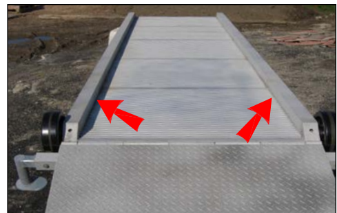
gangplank edge protection
